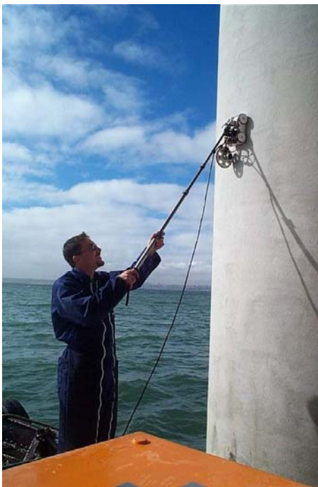
◀ photo 2.1 : Détection des armatures au radar
