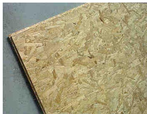
Propriétés des OSB définies par NF P 21-400 (panneaux conformes à NF EN 300), pour calculs avec CB 71 :
